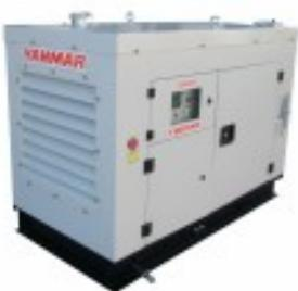
Um Grupo Gerador Yanmar **YBG40TE SILENT AUTOMÁTICO**, com acoplamento direto, equipado com motor Diesel de partida elétrica, trifásico 110/220V, potência máxima de 40 KVA e potência nominal de 36 KVA, 1800 Rpm, 60 hz, capacidade do tanque de combustível de 113 litros, consumo de 7,4 litros por hora com 75 % da carga, 85 DCBS a 7 metros de distância **A bateria que acompanha este equipamento é cortesia do fabricante, portanto não é aplicada garantia desse item.**
